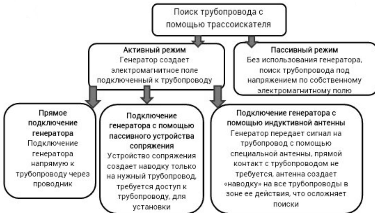
**Рисунок 3.** Поиск трубопровода с помощью трассоискателя.
