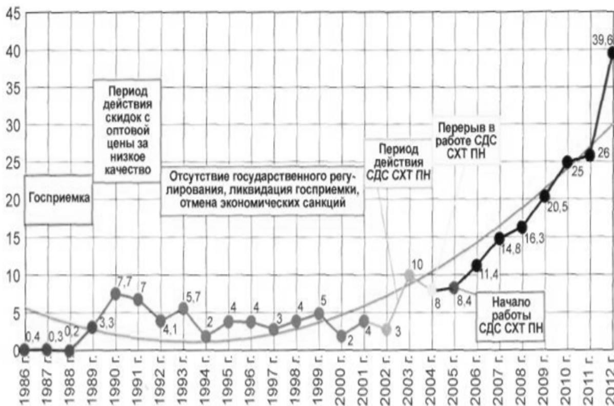
**Рисунок 1.** Количество техники отечественного производства, не имеющей отклонений от требований ТУ (от общего количества испытанных машин), %
